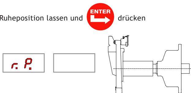
3. Die Abstandsmesslehre Schieber mit Flanschebene ausrichten und **ENTER** drücken
