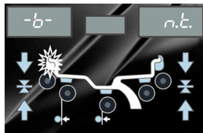
Zur automatischen Messung der Radbreite mittels Sonar LA Radschutzhäube langsam senken und Messlauf durchführen.
