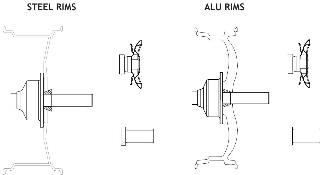
8. Rad mit Spannrad befestigen. Bei pneumatischer Ausführung, Die mitgelieferte Spezialspannvorrichtung benutzen. Für den Betrieb der Spindelwelle mit automatischer Aufspannung (Gasdruckfedern mit konstanter Kraft) ist die Maschine an das Druckluftnetz anzuschließen. Das Anschlussstück befindet sich an der Geräterückseite. Für den korrekten Betrieb der Spannvorrichtung sind mindestens  $7 \text{ kg/cm}^2$  (~0.7 MPa; ~7 bar; ~105 psi) erforderlich.
