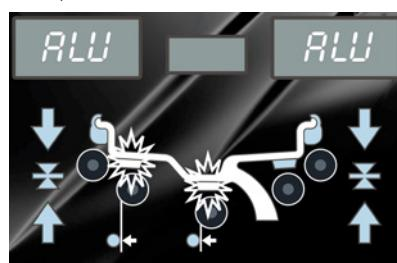
Bei falscher Eingabe der Radabmessungen können diese geändert werden, ohne den Messlauf wiederholen zu müssen.
