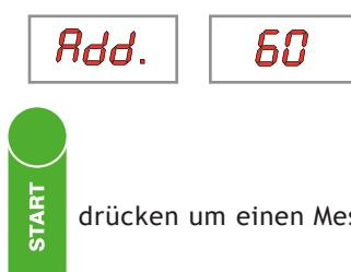
Radschutzhaube schließen und Taste drücken um einen Messlauf auszuführen.
