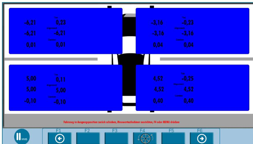
Schieben sie das Fahrzeug in die Ausgangsposition und drücken F4. Vermeiden sie die Unterbrechung oder Ablenkung des Messstrahls zwischen den MWA.
