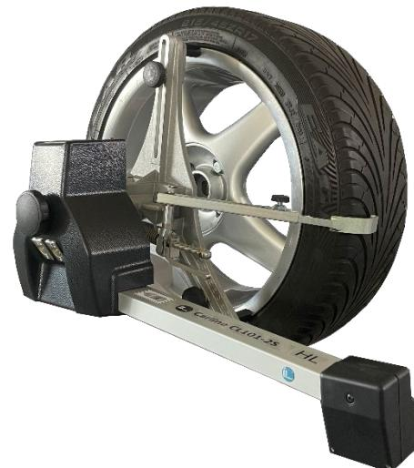
Eine Felgenschlagkompensation ist nicht zwingend erforderlich, wenn die Felge unbeschädigt ist. Das Fahrzeug bleibt im Fahrzustand, ein Anheben des Fahrzeugs ist nicht nötig.
