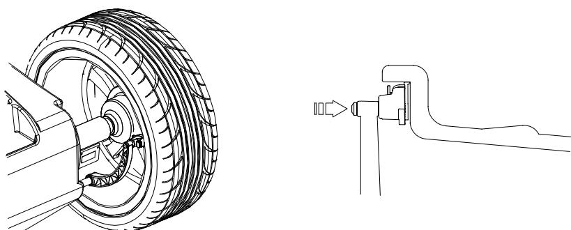
Messarm mindestens 2 Sekunden lang in dieser Position halten. Ist das akustische Signal aktiviert ( MENÜ - AKUSTISCHES SIGNAL), wird die erfolgte Messung durch einen Ton signalisiert.
