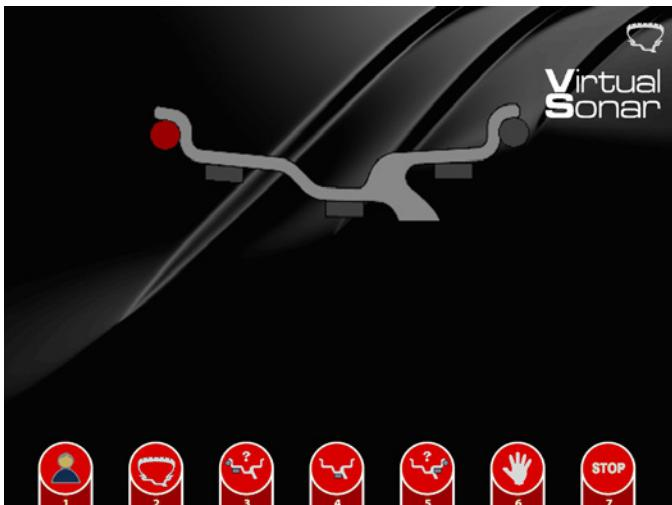
Bei der Standardeinstellung der Maschine als VIRTUAL SONAR (AWA und AUTOADAPTIVE aktiviert) ist nach Abschluss der automatischen Messung des Abstands und des Durchmessers die Messdrehung zu starten.
