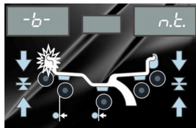
Zur automatischen Messung der Radbreite mittels Sonar LA Radschutzhülle langsam senken und Messlauf durchführen.
